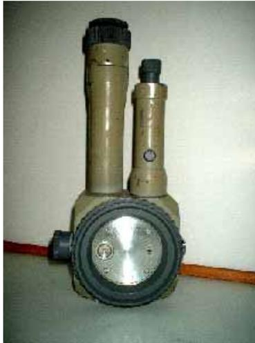
El principio de la precipitación térmica, por su parte, consiste en el paso forzado del aire contaminado con partículas sólidas a través de una cavidad en que se encuentra un filamento metálico dispuesto transversalmente al flujo, que se calienta por el paso de corriente eléctrica y produce una desviación de la trayectoria de las partículas en dependencia de su inercia (figura 49). Al desviarse de
