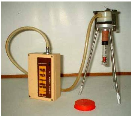
**Figura 32. Verificación de una bomba manual de aspiración**
