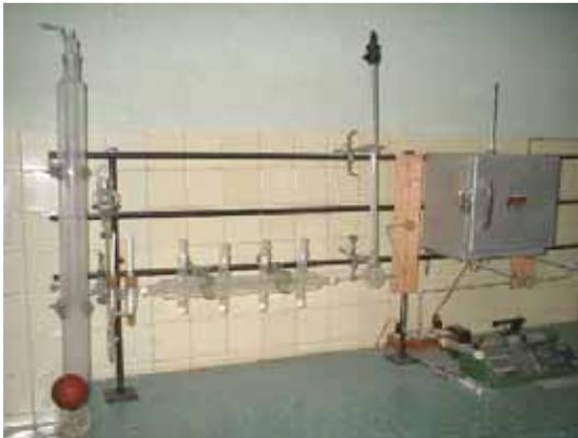
En las cámaras dinámicas, la generación del contaminante debe ser constante y las muestras de aire pueden tomarse perfectamente. La dificultad principal de este método radica en la necesidad de controlar rigurosamente la generación de la sustancia nociva, su dilución con aire y la correspondiente homogenización de la mezcla.
