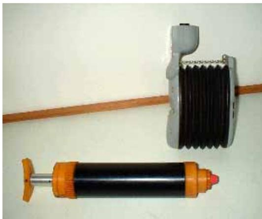
**Figura 25. Bomba manual de aspiración modificada**
