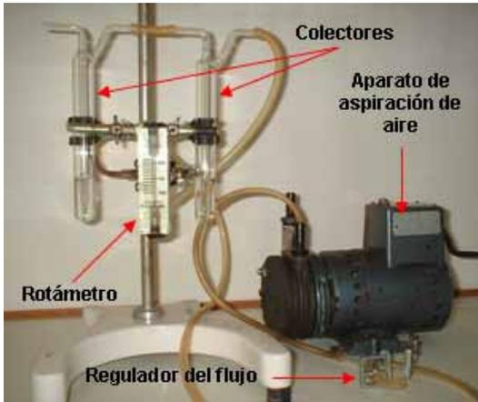
Los colectores de muestras ambientales se clasifican de acuerdo con el estado de agregación de la sustancia objeto de análisis y con la forma específica de retención que se pretenda utilizar.
