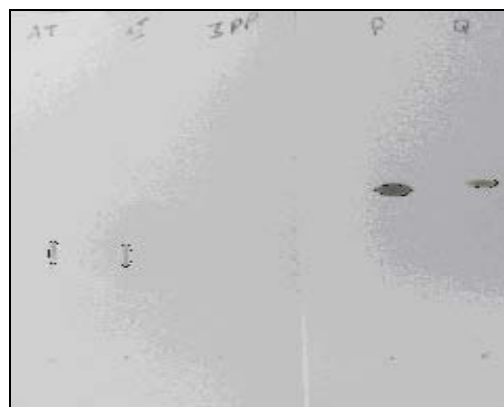
Figura 3. Placa de CCD que muestra las manchas correspondientes al ácido tánico (AT), la muestra (MI), la muestra tratada con polvo de piel (IPP), al pirogalol (P) y quercetina (Q)
