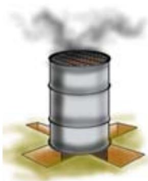
Este incinerador se utiliza para la disposición de basura seca (papeles, hojas, etc.) o de poca humedad, que pueden quemarse sin gasto de petróleo u otro combustible. Esta instalación debe ubicarse a más de 400 m de los lugares destinados a vivienda.
