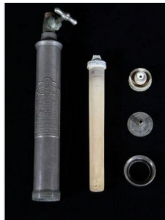
Componentes de un filtro de Pasteur-Chamberland
